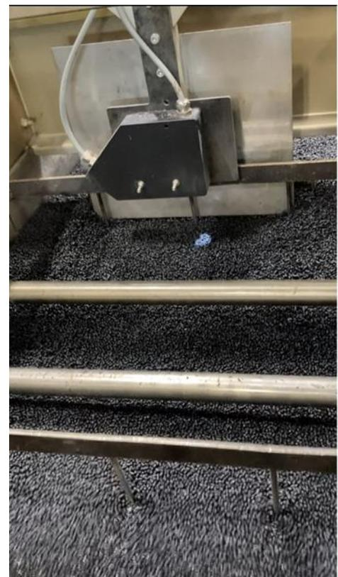
bis zu 60s eingestellt werden. Als ideales Zeitfenster hat sich schon bei den ersten Tests ein Fenster von 15s herauskristallisiert. Bei einer Rezyklatstromgeschwindigkeit von 50mm/s bis 100mm/s ergibt sich dabei eine Messlänge von 750mm bis 1500mm. Vor der eigentlichen Farbmessung der verschiedenen Rezyklate wurde die Temperatur des Rezyklatstroms an der Messposition sowie die Gehäusetemperatur des Farbsensorfrontends gemessen.
